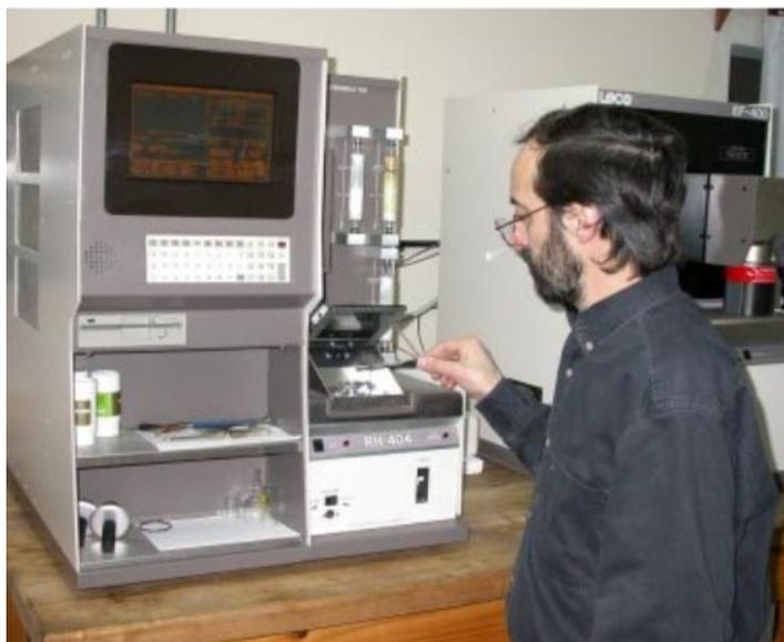
Equipo **LECO** para determinación de hidrógeno en muestras metálicas de alto punto de fusión
