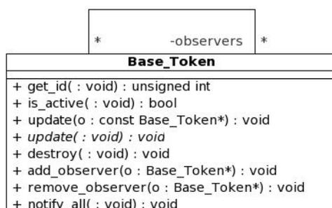
*Figura A.1:* La clase base los elementos lógicos, los controladores y los elementos visuales
