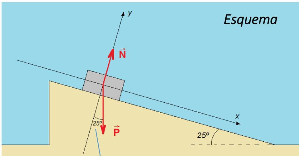
El ángulo entre el peso y el eje de las  $y$  es igual al ángulo de inclinación del plano (verifíquelo).
