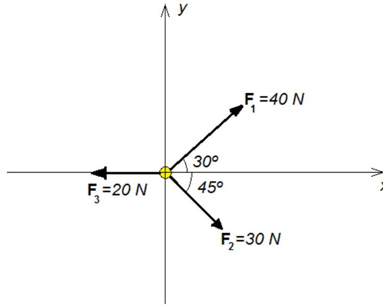
Realizamos la suma de fuerzas en cada eje, y aplicamos la 2da ley de Newton para encontrar las componentes de la aceleración
